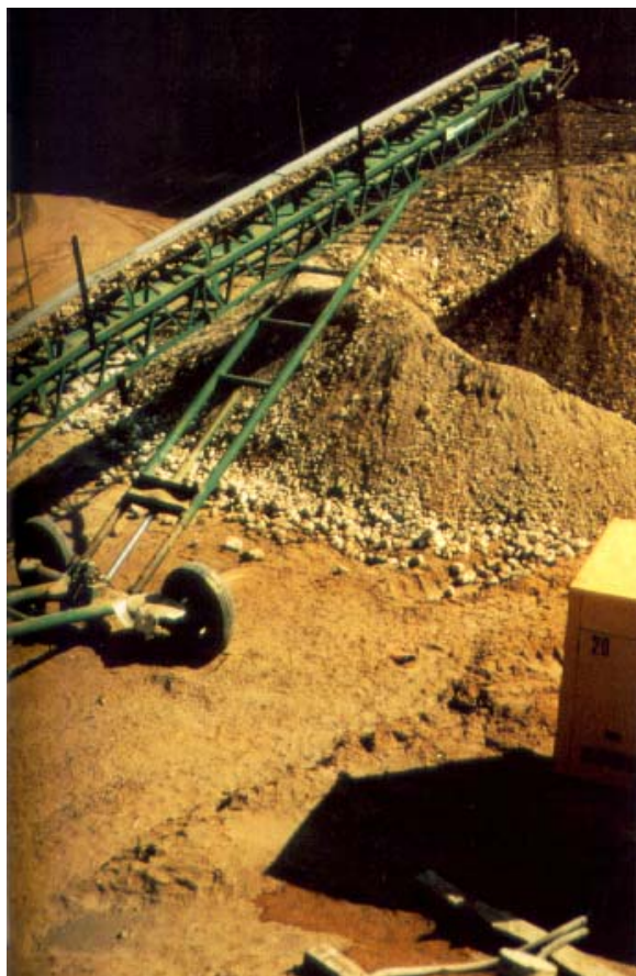
A esteira transporta o material britado, formando pilhas de agregado reciclado.
